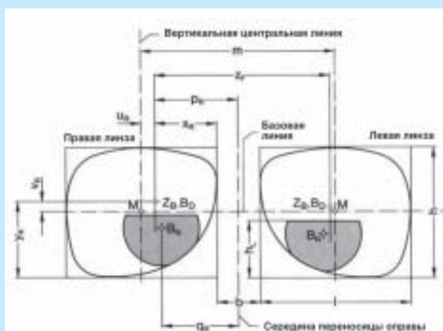
Рис.18.1. Положение точек оптического центрирования ( M – геометрический центр линзы, Z_B – точка оптического центрирования, z_f – центровочное расстояние, m – расстояние между геометрическими центрами шаблонов линз в оправе)
