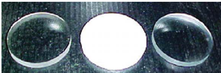
Линзы, выдержанные в ацетоне в течение 10 суток: CR-39, поликарбонат, Trivex (слева-направо)
